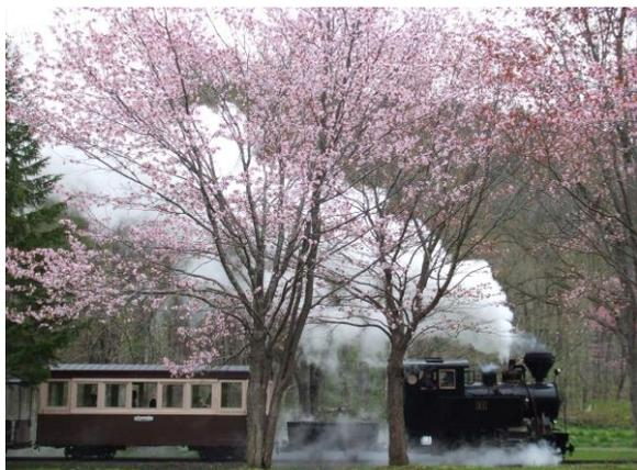
この機関車は、台湾の植民地鉄道用に向けられたワルシャート型(15t車)が原型で、北海道庁からの委託により、雨宮製作所の主任技師が国鉄と同じレール幅の1,067mmの機関車を森林鉄道向けの762mmに設計しなおし、製造されたものと言われている。
